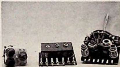
Bild 4. Die mit der Musterschaltung probierten Spulensätze. Links: ES 1 der Hochfrequenzwerkstätten Meuselwitz, entspricht Görlzer F 296; Mitte: Topfkreis, Spulensatz 1947, Hersteller unbekannt; Rechts: Neumann Sp 122 (Conrad, Fern)
